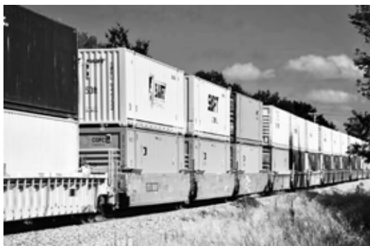
Contenedores en dos niveles sobre las vías del tren.
